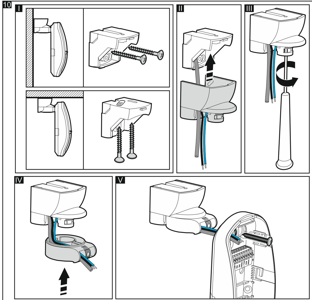
6. Pripojiť vodiče na zodpovedajúce svorky. Ak je detektor montovaný na konzolu, treba sabotážny kontakt konzoly pripojiť sériovo na sabotážny výstup detektora. Spôsob pripojenia sabotážneho kontaktu zobrazujú obrázky 13 (konfigurácia NC), 15 (konfigurácia 2EOL) a 17 (konfigurácia 3EOL).
