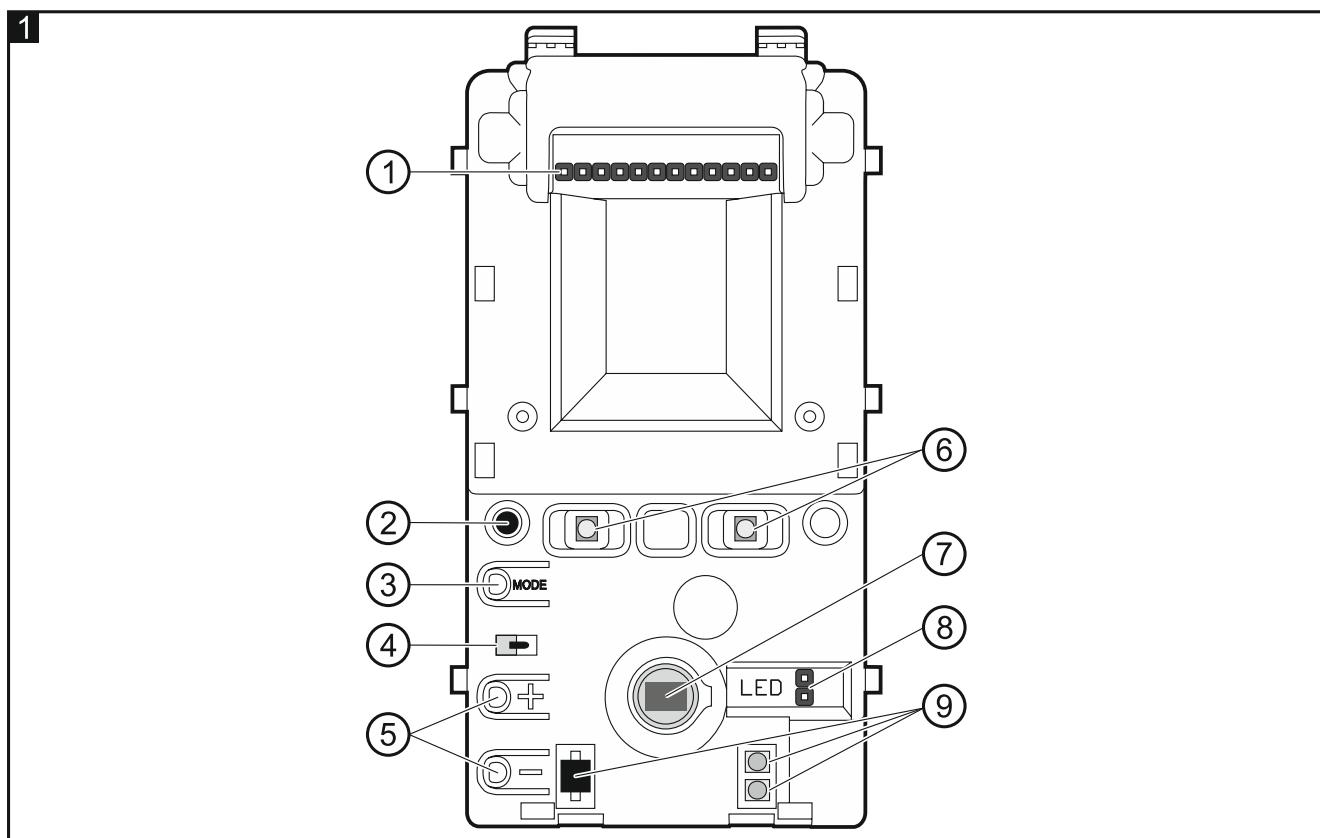
① jumper na konfiguráciu výstupov detektora. Dostupné nastavenia zobrazujú obrázky:
